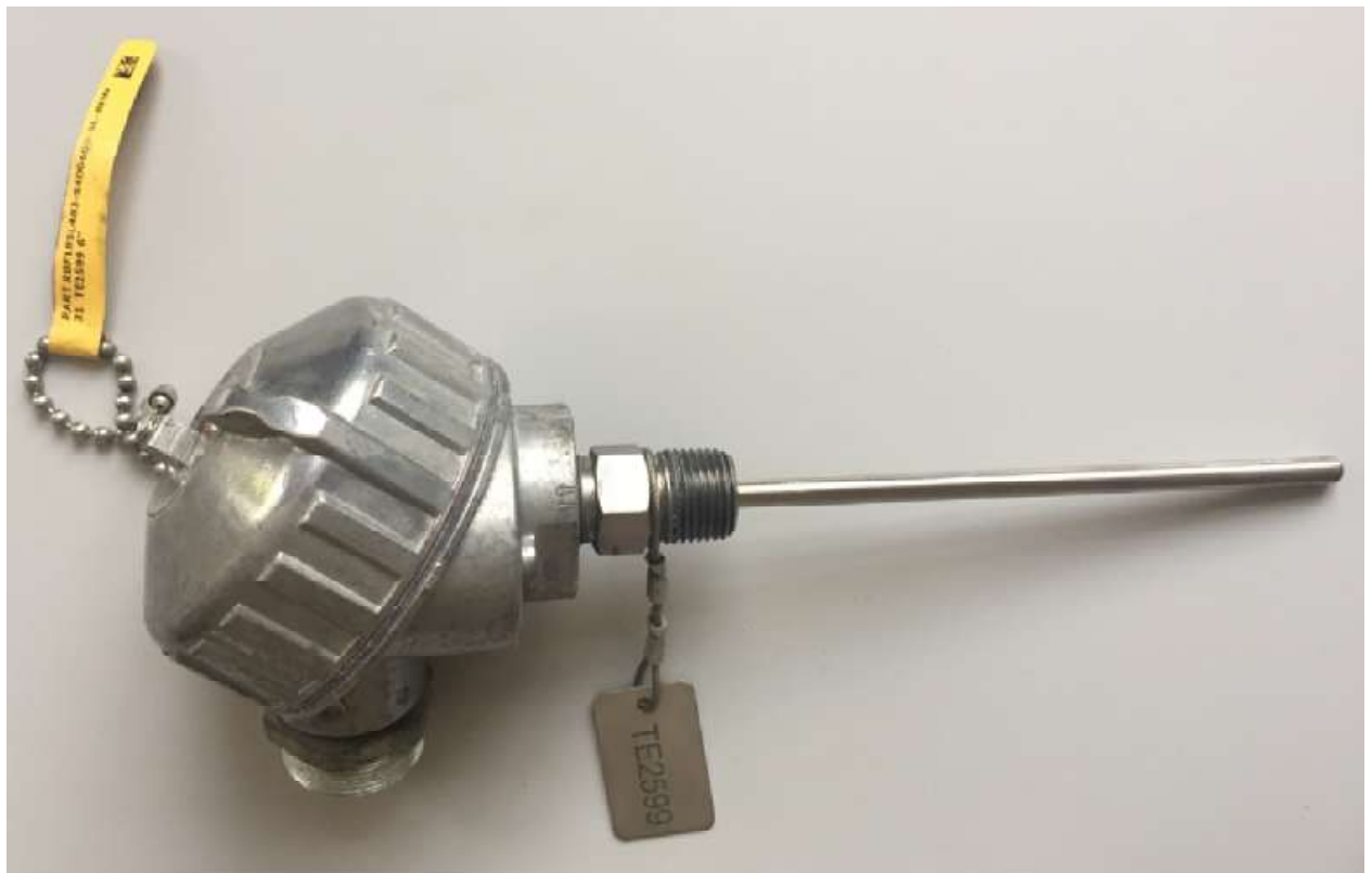
Рисунок 1 - Общий вид термопреобразователей сопротивления платиновых RBF185L483
