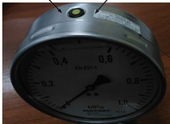
Рисунок 23 - Места нанесения знака утверждения типа и знака поверки, таблички с местом нанесения заводского номера
