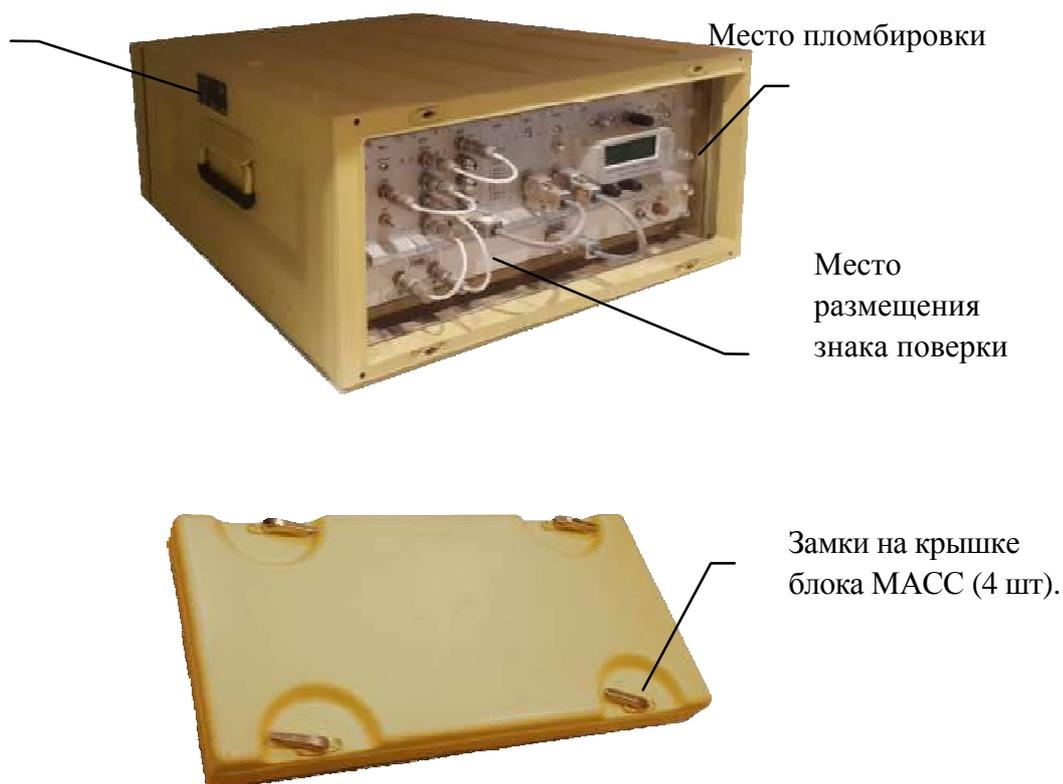
Рисунок 3 – Общий вид блока МАСС, схема пломбировки от несанкционированного доступа и место размещения знака поверки
