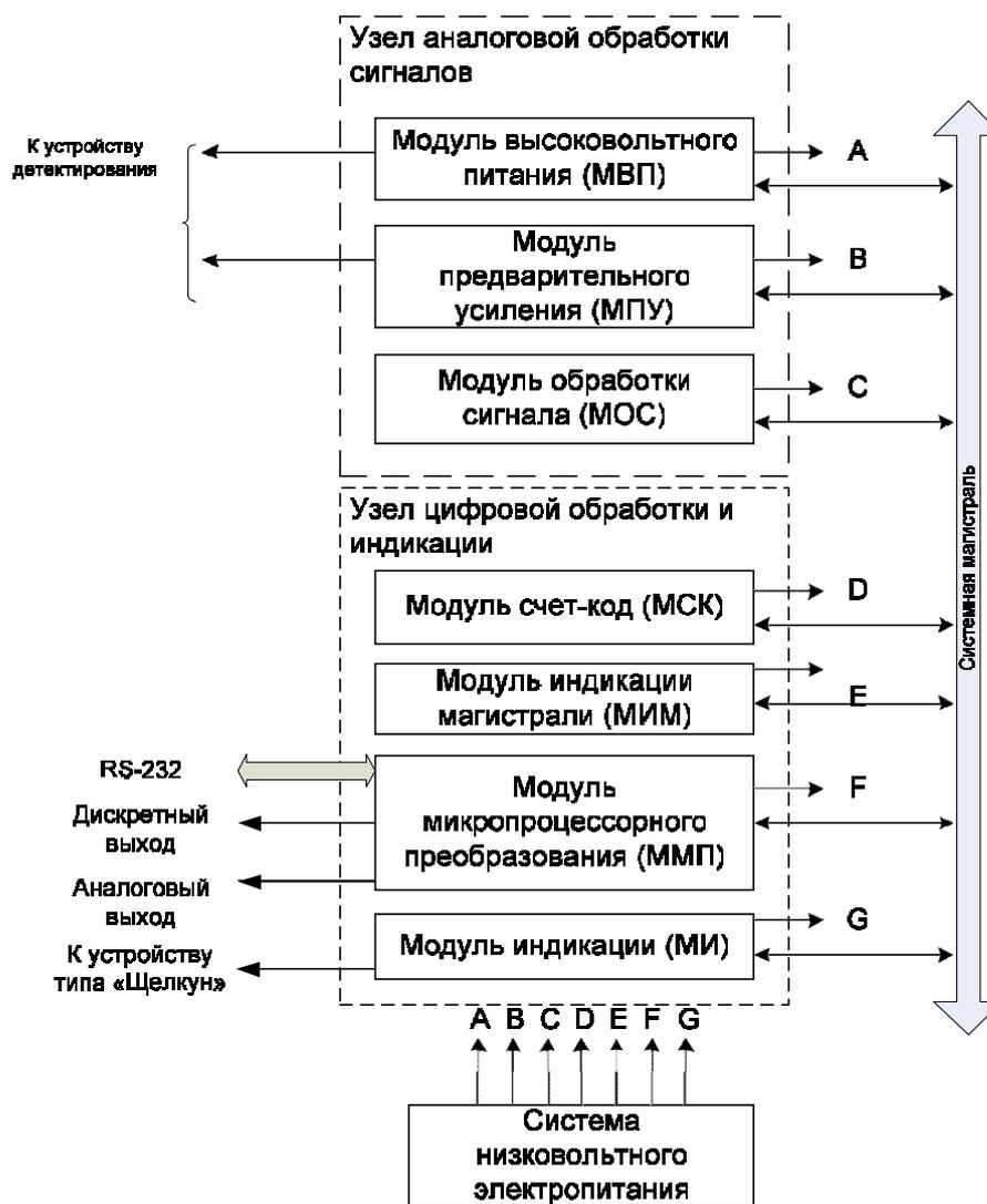
Рисунок 2 - Структурная схема одного блока МАСС
