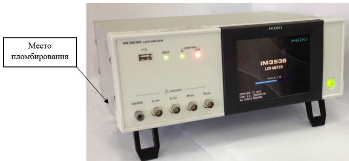
Рисунок 1 - Общий вид измерителей иммитанса IM3536
