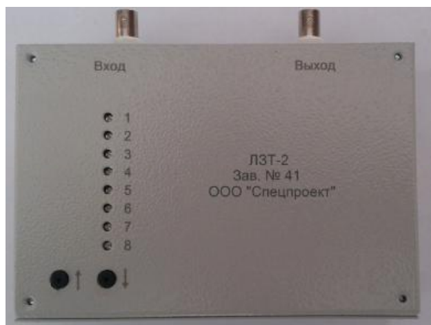
Рисунок 2 - Линия задержки ЛЗТ-2
