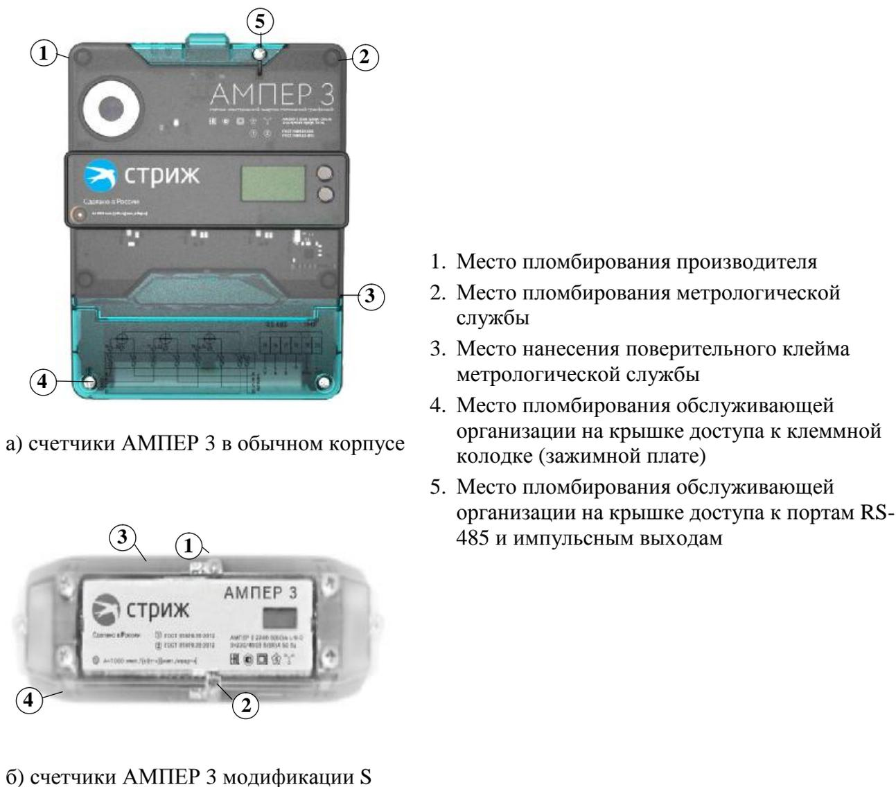
Рисунок 1 – Общий вид счетчиков и схемы пломбировки
