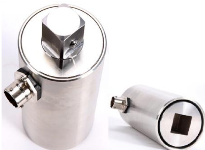
Рисунок 4 - Общий вид первичных измерительных преобразователей серии STT
