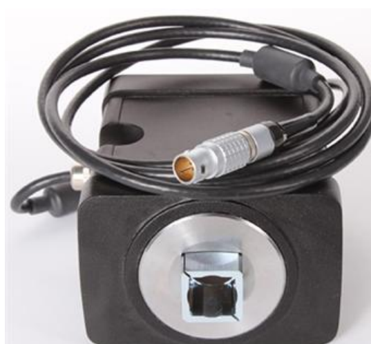
Рисунок 3 - Общий вид первичных измерительных преобразователей серии STB
