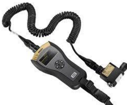
Рис. 1. - Общий вид измерителей крутящего момента силы цифровых IRTT
