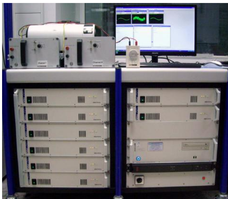
Рисунок 1 – внешний вид системы (на столе показаны два согласующих четырехполосника и калибратор).
