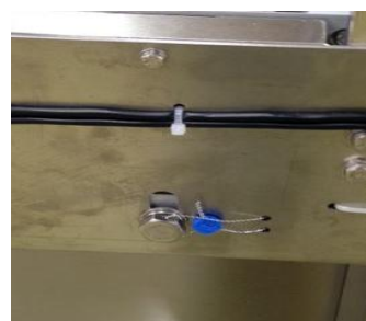
Пломбировка элементов крепления ГПУ
