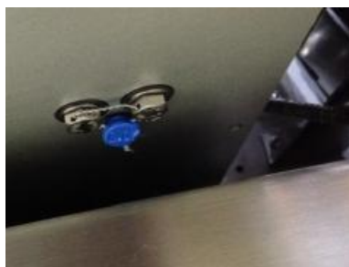
Пломбировка весоизмерительного датчика
