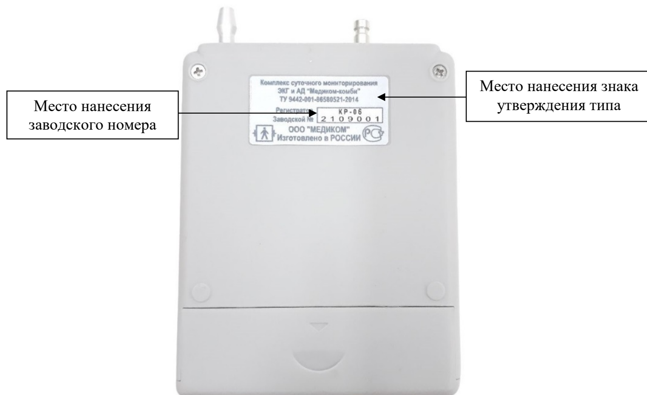
Рисунок 1 – Общий вид средства измерений с указанием мест нанесения знака утверждения типа и заводского номера
