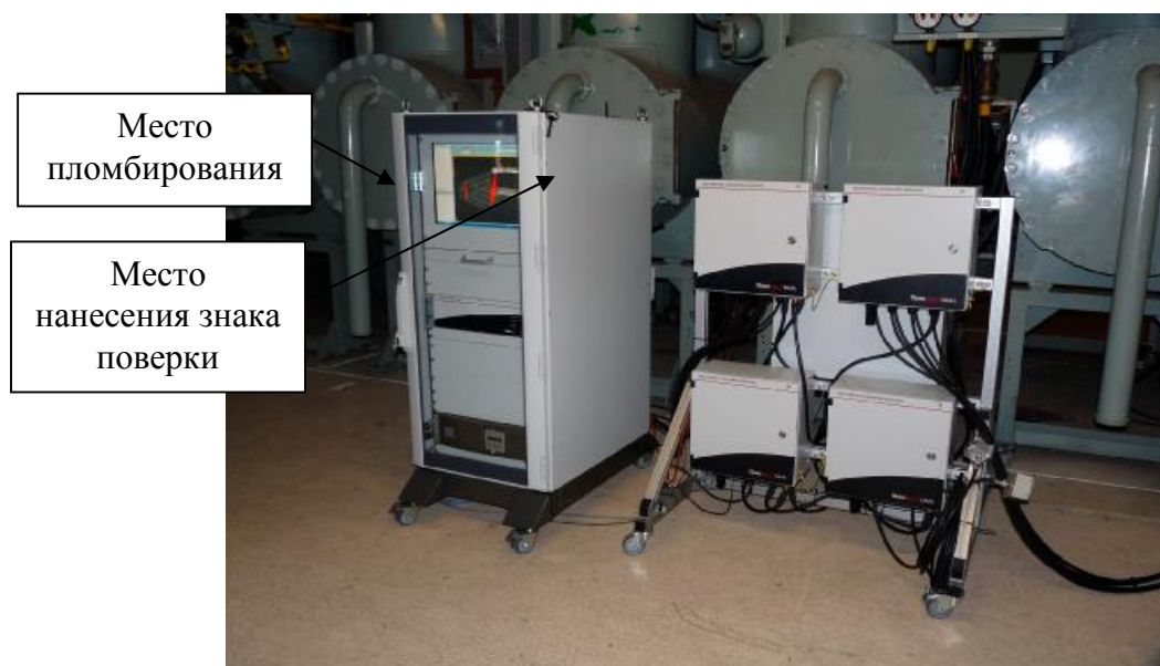
а. Модификация PDMG-R (PDMG-RH) с четырьмя БОП
