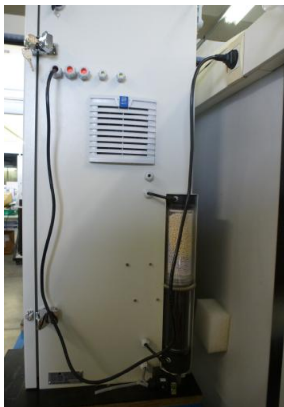
Рисунок 2 - Боковая панель анализатора с установкой по очистке воздуха
