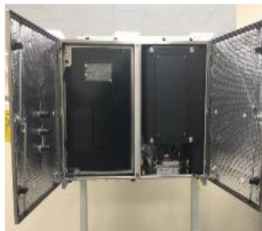
Рисунок 1 - Общий вид анализаторов растворенных газов в трансформаторном масле TOTUS
