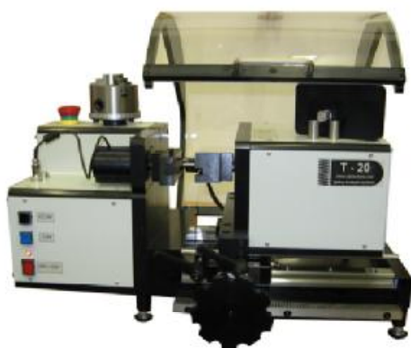
Рисунок 1 - Внешний вид машин для испытаний пружин и материалов на кручение T-0.01, T-0.1, T-2, T-20
