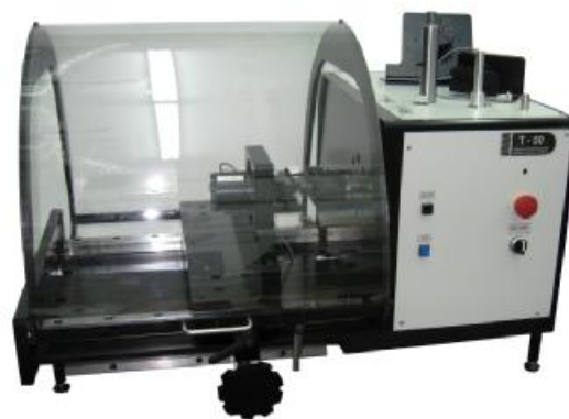
Рисунок 2 - Внешний вид машин для испытаний пружин и материалов на кручение T-50, T-100
