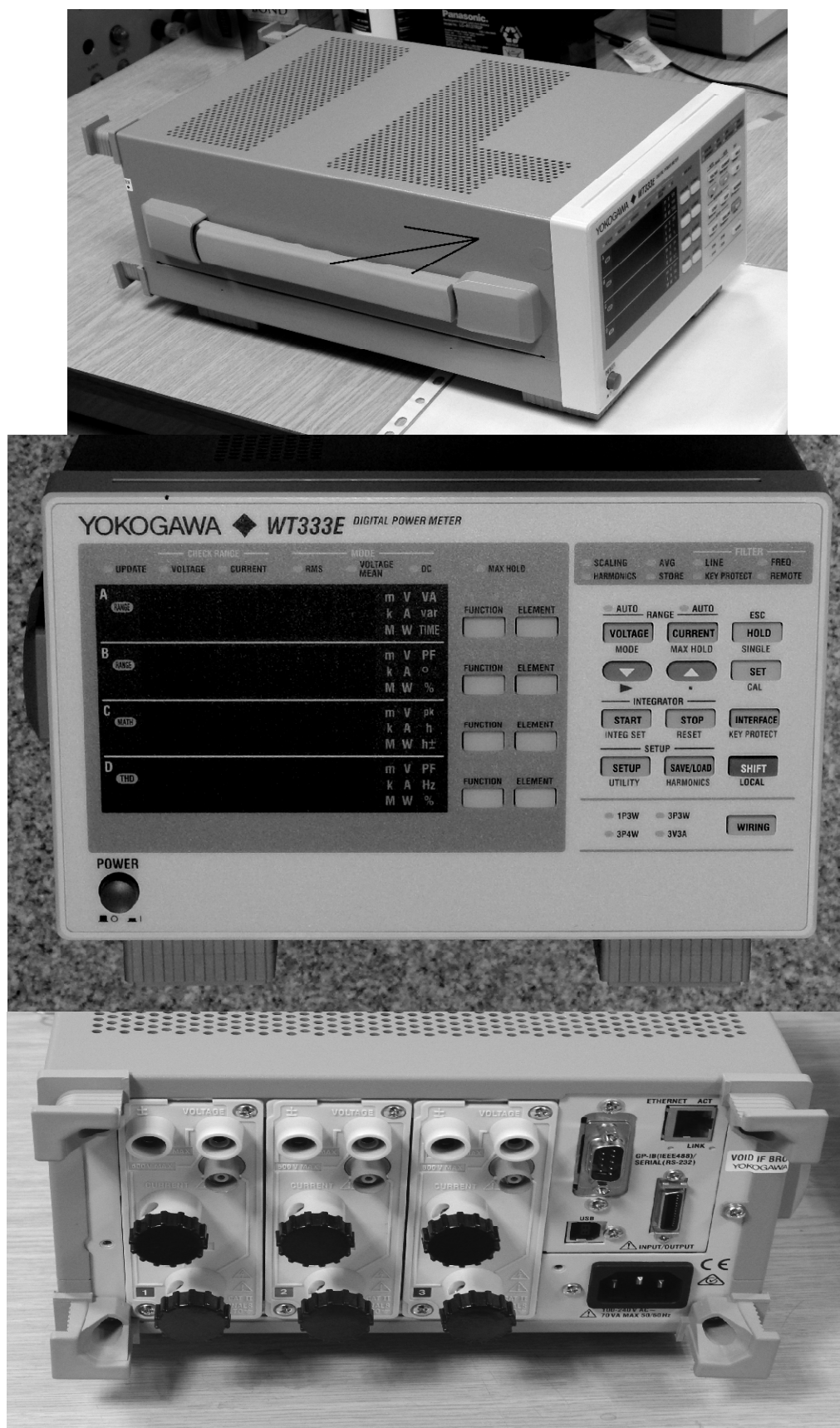
Рисунок 2 - Внешний вид измерителя WT333E Стрелкой показано место нанесения знаков утверждения типа и поверки
