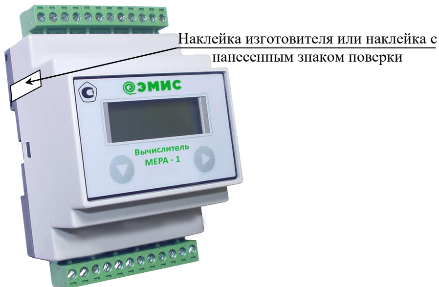
Рисунок 4 - Схема пломбировки вычислителя счетчиков раздельного исполнения
