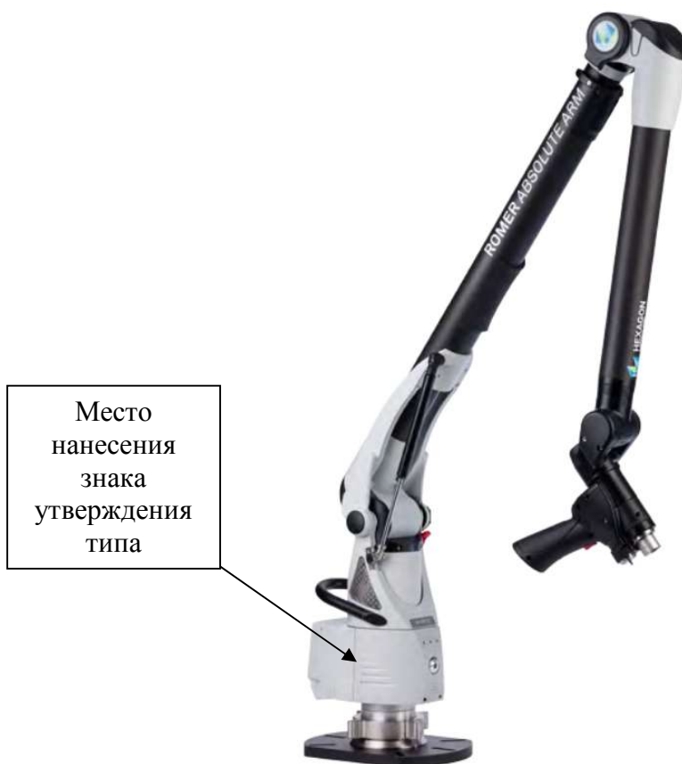
Рисунок 3 - Общий вид машины семиосевой модификации с внешним лазерным сканером
