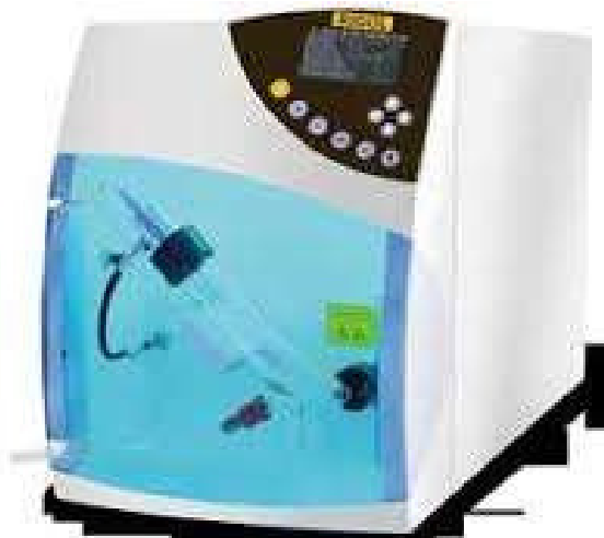
Рисунок 5 - Фотография внешнего вида детектора по светорассеянию L-3535
