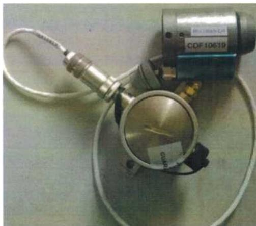
Рисунок 1 - Общий вид датчиков силоизмерительных тензорезисторных серии MLC160
