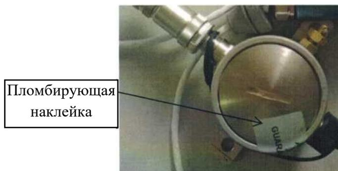
Рисунок 2 - Место нанесения пломбирующей наклейки
