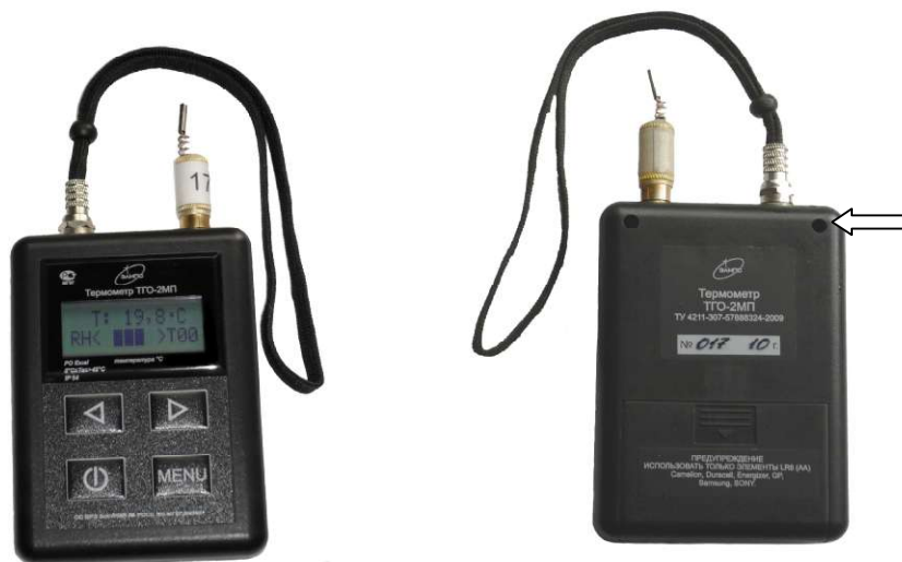
Рисунок 1 - Общий вид термометра и место пломбирования корпуса (указано стрелкой)
