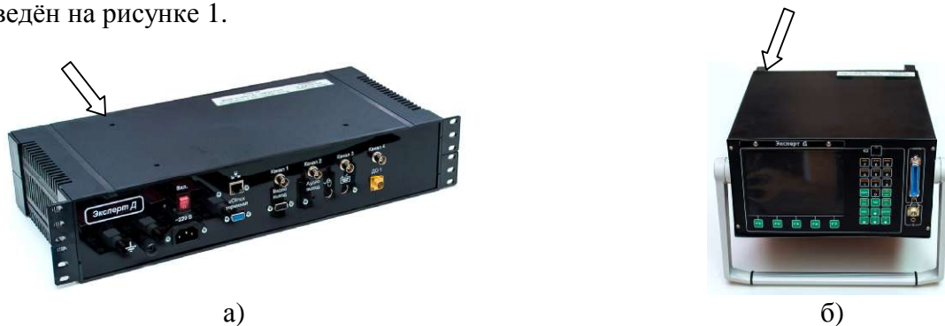
Рисунок 1 - Внешний вид комплексов в стационарном (а) и переносном (б) вариантах исполнения и места их пломбирования (указаны стрелкой)
