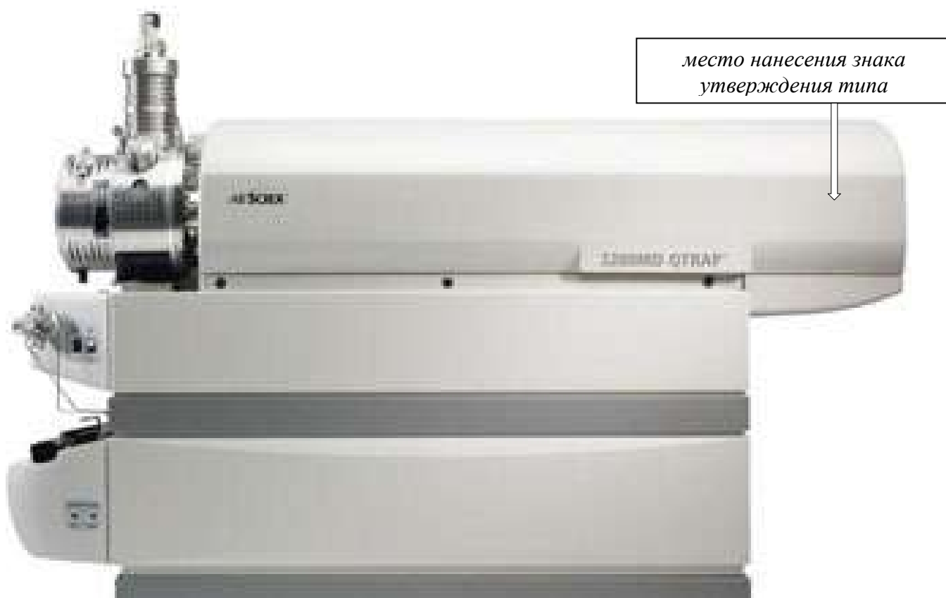
Рисунок 2 - Общий вид масс-спектрометров «3200MD QTRAP» и обозначение места нанесения знака утверждения типа
