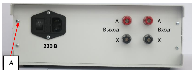
Рисунок 2 - Схема пломбировки от несанкционированного доступа (А и Б)
