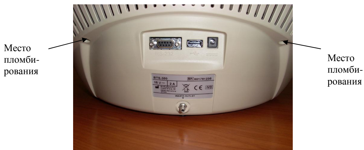
Рисунок 3 - Схема пломбировки от несанкционированного доступа
