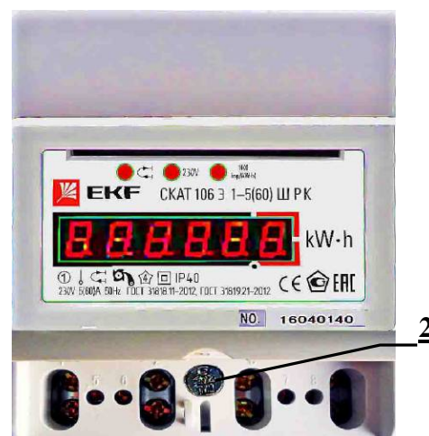
Рисунок 4б Общий вид счетчика с цифровой СД индикацией с открытой крышкой
