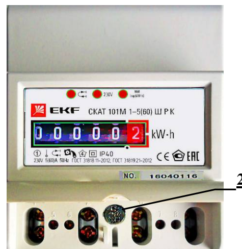
Рисунок 2б Общий вид счетчика с ЭМОУ разрядностью 99999.9 с открытой крышкой
