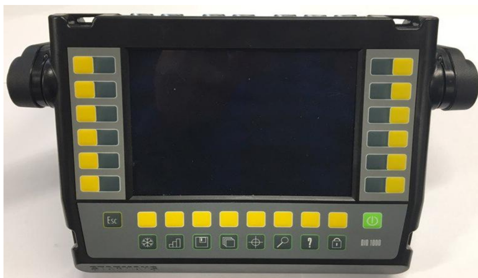
Рисунок 1 - Общий вид дефектоскопов ультразвуковых DIO1000
