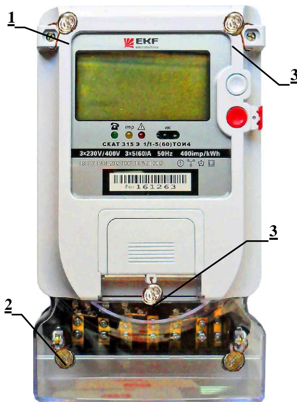
Рисунок 5 Общий вид многотарифного программируемого счетчика активно-реактивной с ЖКИ с интерфейсом RS-485
