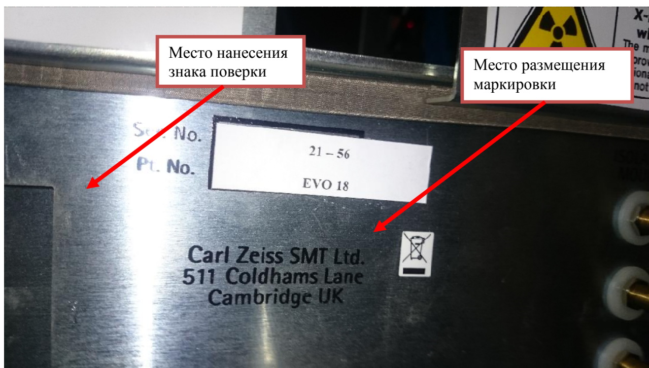
Рисунок 2 - Обозначение места размещения маркировки, места нанесения знака поверки микроскопов сканирующих электронных EVO 18
