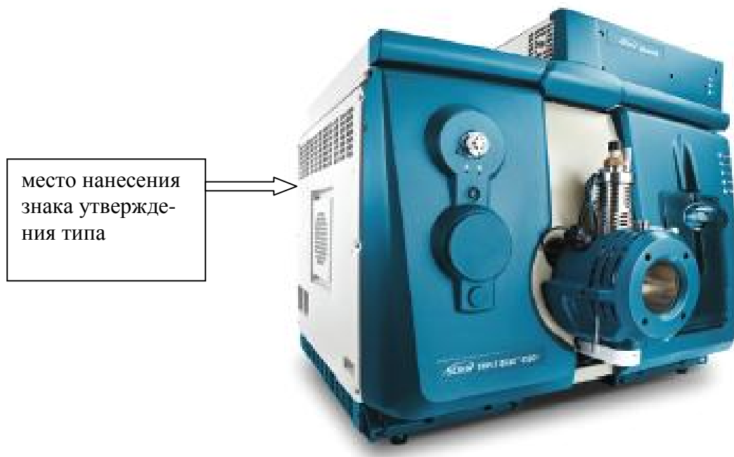
Рисунок 1 - Общий вид масс-спектрометра Triple Quad 6500+ и обозначение места нанесения знака утверждения типа
