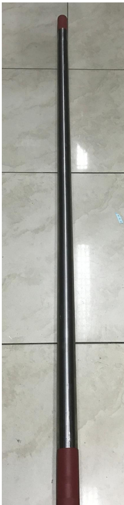
Рисунок 1 - Общий вид забойной части инклинометров (зонд)
