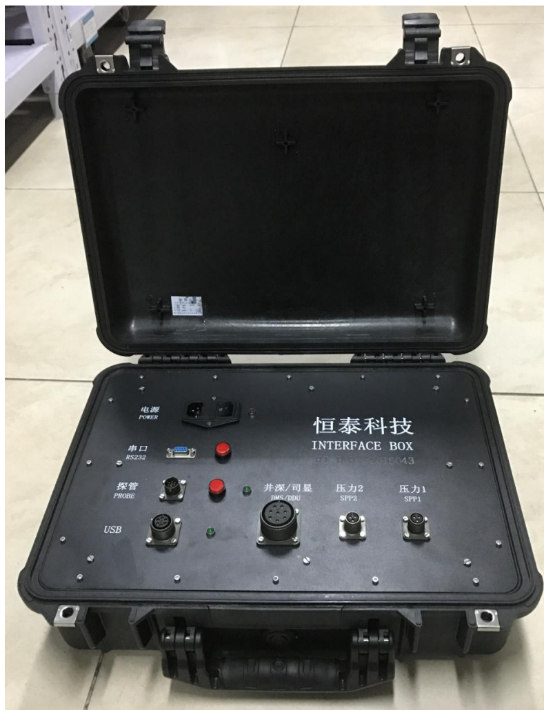
Рисунок 2 - Общий вид наземной части инклинометров (блок интерфейса)
