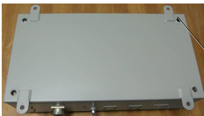
Рисунок 4 - Схема пломбировки он несанкционированного доступа блока БКР-У
