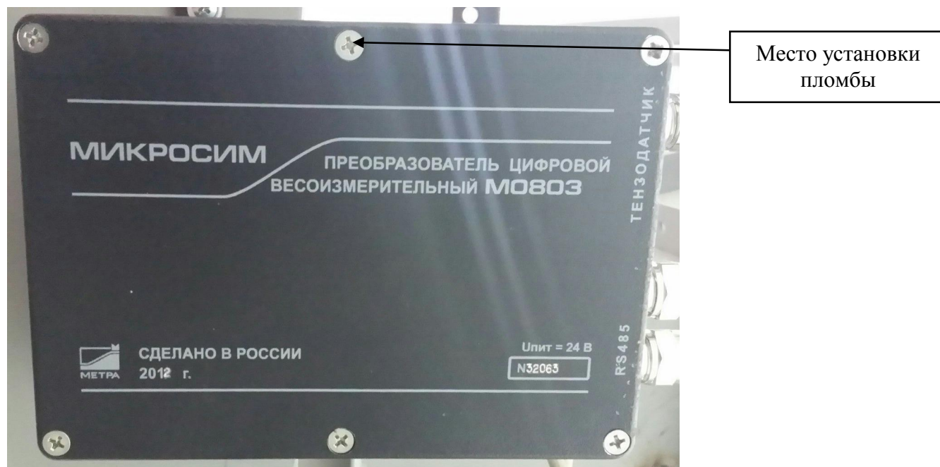
Рисунок 2 - Общий вид и схема пломбировки от несанкционированного доступа преобразователя цифровой весоизмерительный M0803
