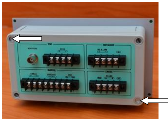
Рисунок 2 - Схема пломбировки от несанкционированного доступа, обозначение места нанесения знака поверки блока электронного НОРД-ЭЗМ-01
