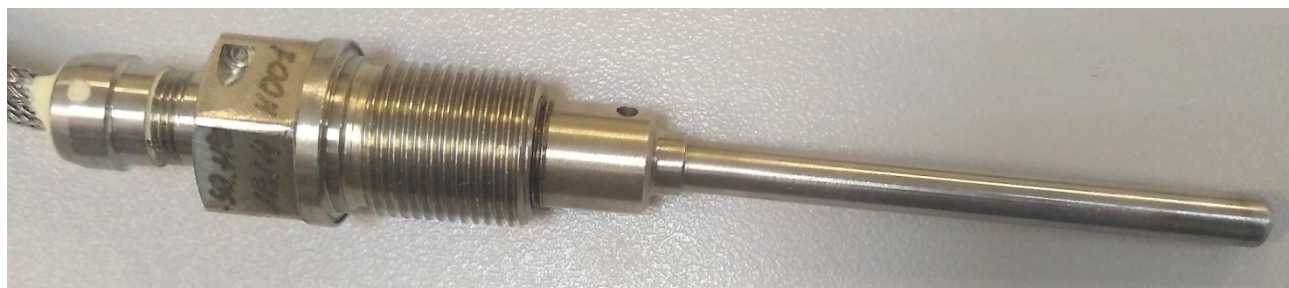
Рисунок 3 – Общий вид корпуса термопреобразователя с защитной гильзой.
