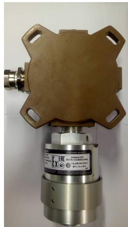
Рисунок 4– Место нанесения маркировки (Маркировка торговой марки Net Safety является маркировкой «Rosemount Inc.», США)
