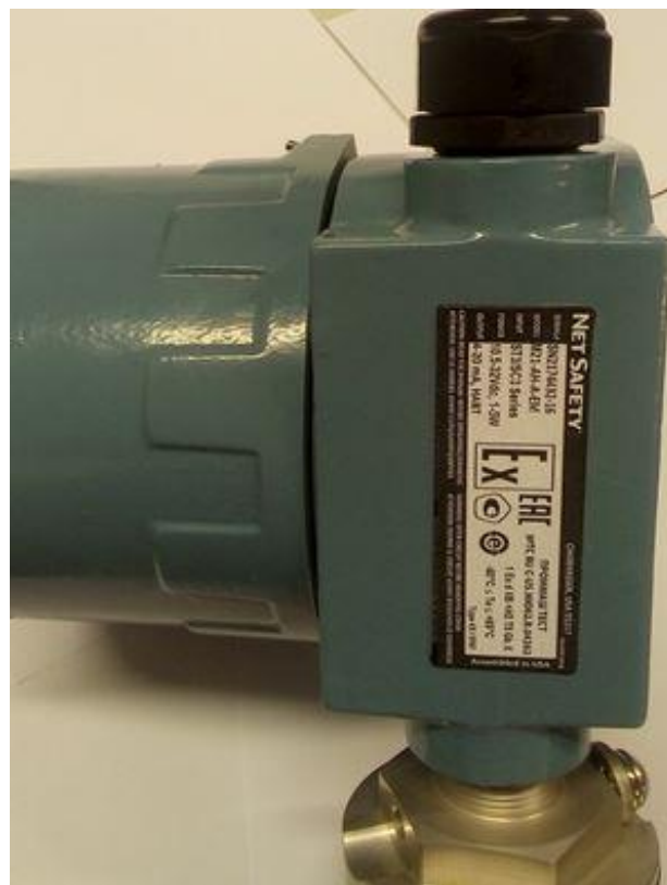
Рисунок 2 – Место нанесения маркировки (Маркировка торговой марки Net Safety является маркировкой «Rosemount Inc.», США)
