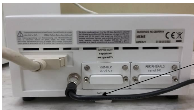
Рисунок 2 - Схема пломбирования от несанкционированного доступа
