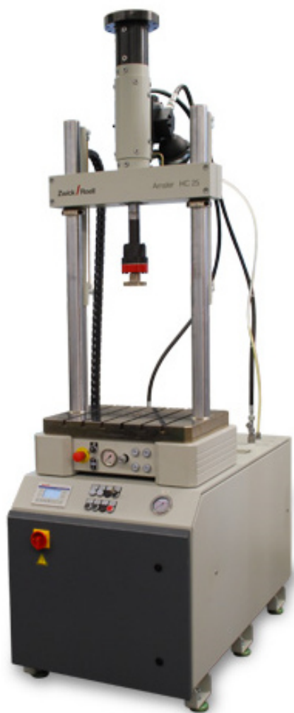
Рисунок 1 - Общий вид машин универсальных испытательных HC10, HC25
