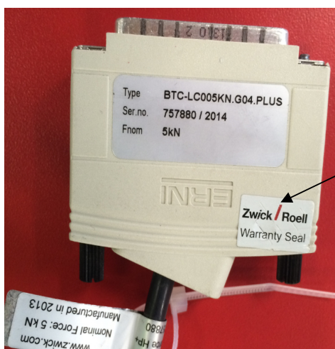
Рисунок 5 - Место нанесения пломбировки
