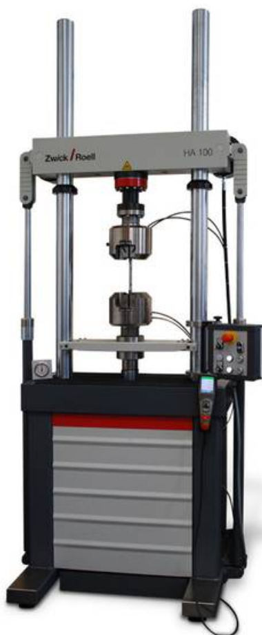
Рисунок 3 - Общий вид машин универсальных испытательных HA50, HA100, HA250, HA500
