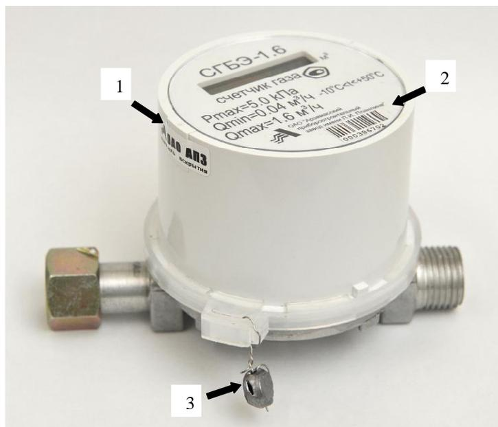
Рисунок 1 - Общий вид и схема пломбирования счётчиков газа
