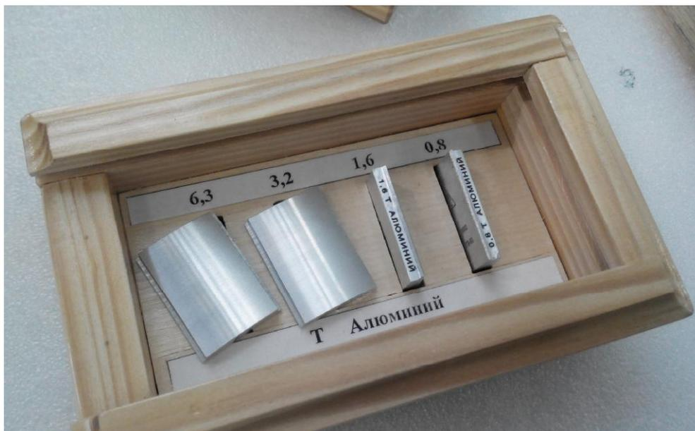
Рисунок 2 – Общий вид образцов шероховатости из алюминия
