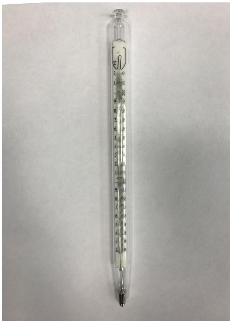
Рисунок 1 - Общий вид термометров максимальных стеклянных СП-83М
