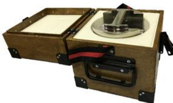
Рисунок 9 – Общий вид гири ГО-П-20 кг Р класса точности F_1 и F_2 , в кейсе
