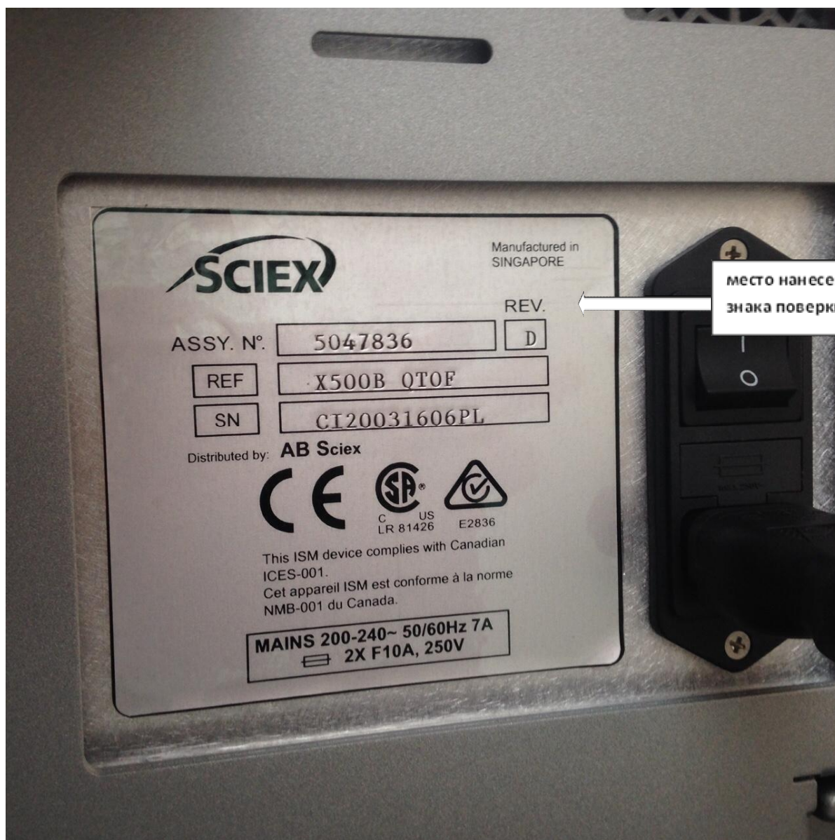
Рисунок 5 - Обозначение места нанесения знака поверки масс-спектрометра X500B QTOF
