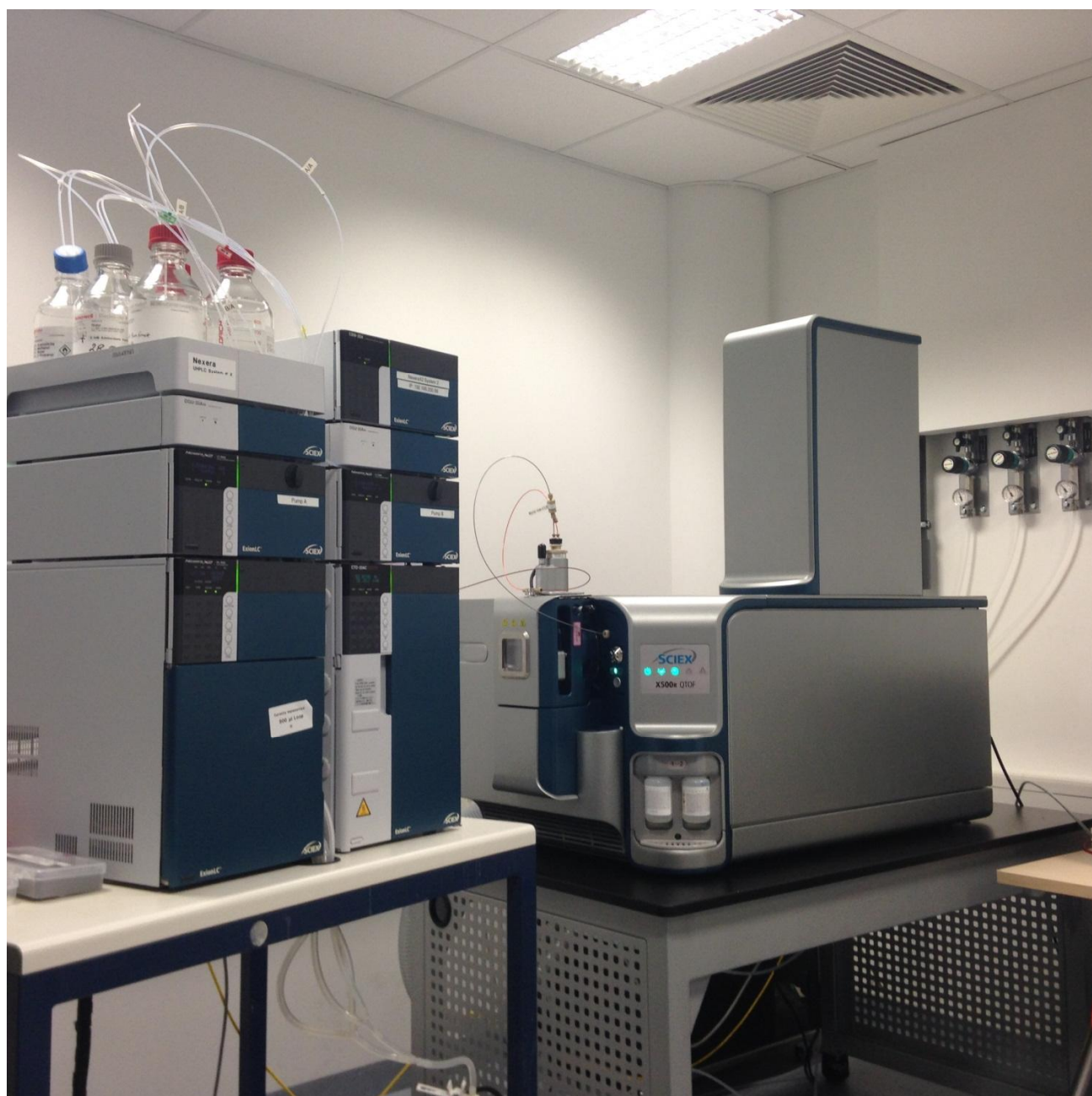
Рисунок 1 - Общий вид масс-спектрометра X500R QTOF и жидкостного хроматографа с емкостями для отходов и необходимыми трубопроводами
