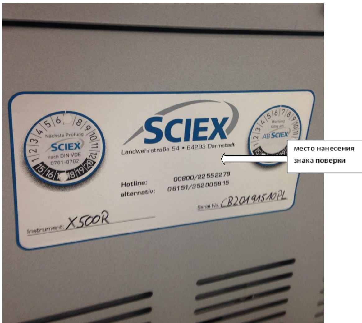
Рисунок 3 - Обозначение места нанесения знака поверки масс-спектрометра X500R QTOF
