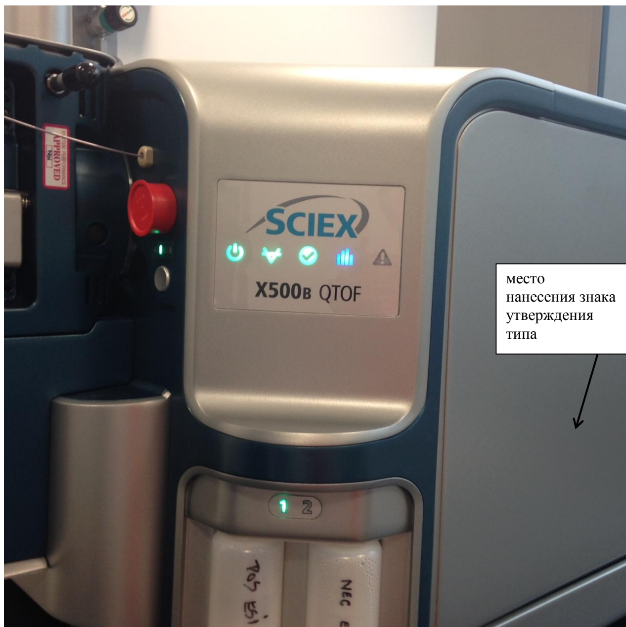
Рисунок 4 - Общий вид масс-спектрометра X500V QTOF и обозначение места нанесения знака утверждения типа
