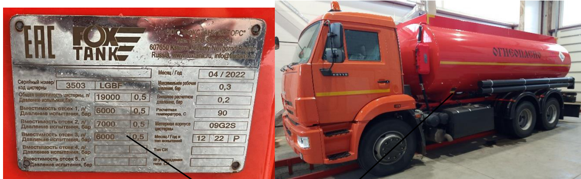
Рисунок 4 – Место нанесения заводского номера АЦ и АТЗ
