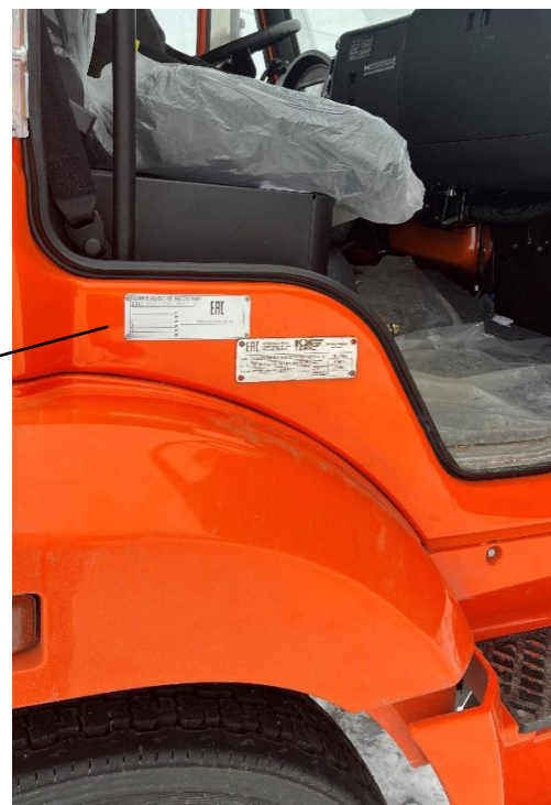
Рисунок 4 – Место нанесения заводского номера АЦ и АТЗ
