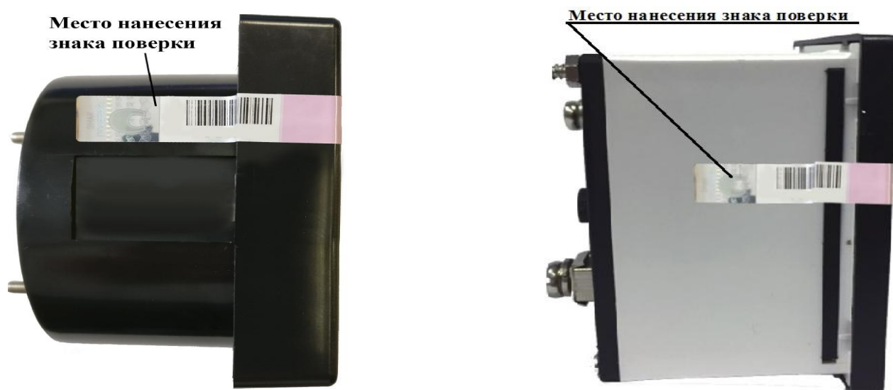
Рисунок 3 - Место нанесения знака поверки на приборах серий Э8030-M1 и 72 TE
