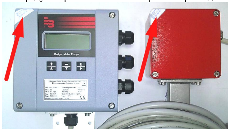
Рисунок 2 - Место пломбирования расходомера
