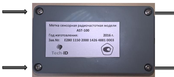
Рисунок 2 - Схема пломбировки меток от несанкционированного доступа, обозначение места нанесения знака поверки
