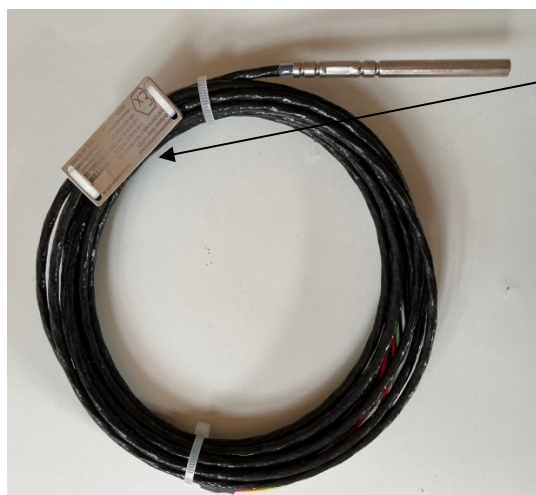
Рисунок 16 - Общий вид термопреобразователей сопротивления платиновых модели Ex21x модификации ExE-KF-OV21A
