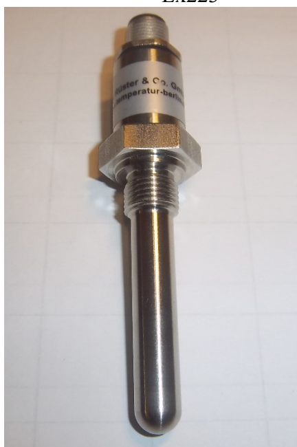
Рисунок 14 – Общий вид термопреобразователей сопротивления платиновых модели Ex211Vi
