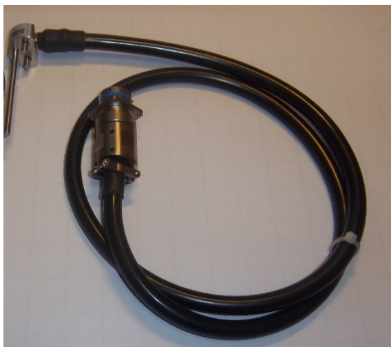
Рисунок 8 – Общий вид термопреобразователей сопротивления платиновых модели 21wх модификации 21w5
