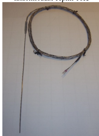
Рисунок 11 – Общий вид термопреобразователей сопротивления платиновых модели 21М
