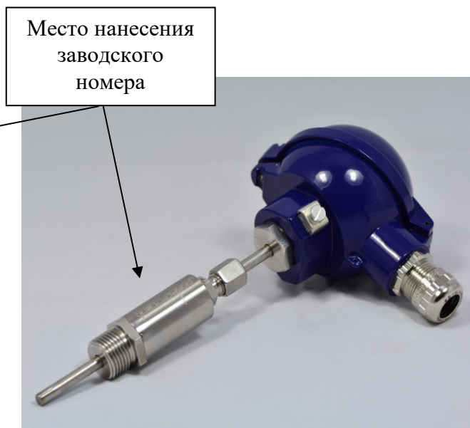
Рисунок 17 - Общий вид термопреобразователей сопротивления платиновых модели Ex2xx модификации ExE-BUZ201
