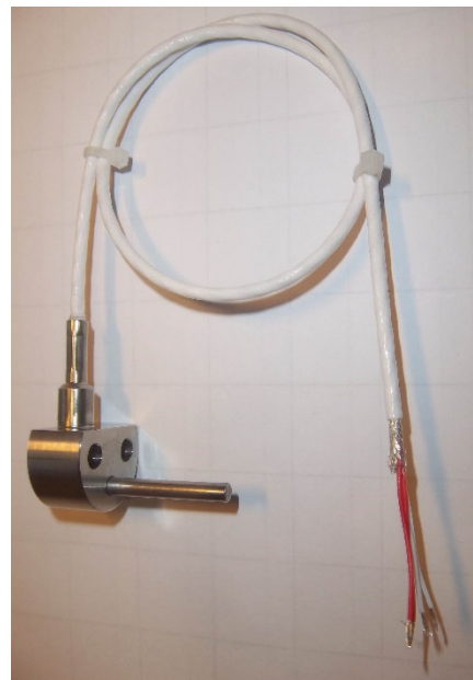
Рисунок 13 – Общий вид термопреобразователей сопротивления платиновых модели Ex21w
