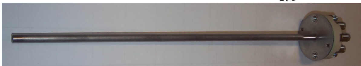
Рисунок 7 – Общий вид термопреобразователей сопротивления платиновых модели 20 (20М)
