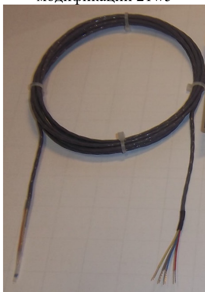
Рисунок 10 – Общий вид термопреобразователей сопротивления платиновых модели 21FEP
