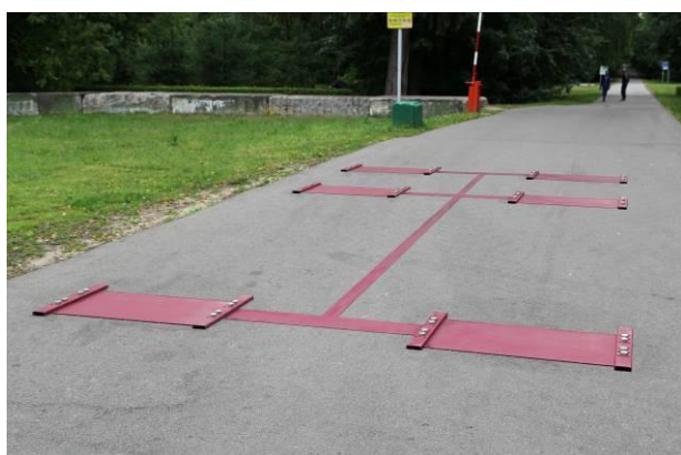
Врезное исполнение ГПУ из шести платформ
