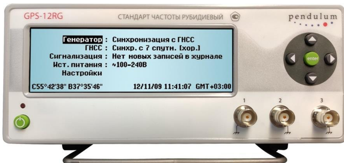
Рисунок 2 – Вариант исполнения лицевой панели с органами управления круглой формы (вариант 2)
